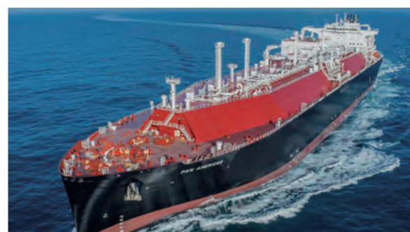
我国首艘 17.4 万立方米 LNG-FSRU
