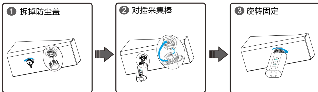
图 3-5 4G 数据采集棒安装
